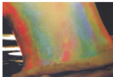
Abbildung 2. Aufnahme eines quervernetzten Polyacrylamid-Hydrogels mit immobilisierten Polybutylacrylatkolloiden. Die der Opaleszenz zugrunde liegende Bragg-Streuung des einfallenden sichtbaren Lichts beweist die kristalline Ordnung der Partikel.
